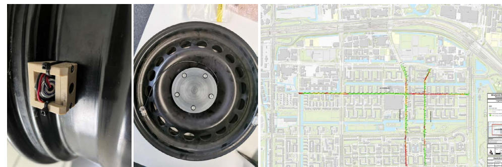
Figuur 16: Figuur links laat de geluidsmeter in de band zien en de figuur rechts geeft een voorbeeld van de gemeten geluidsniveaus weer.
